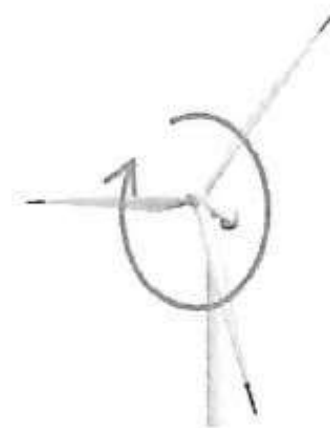
水平軸型風車 回転面を風向に正対させる方位制御が必要である
